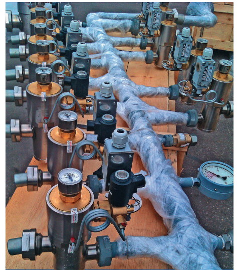
Коллектор из нержавеющей стали для централизованной УГПТ с установленными на него распределительными устройствами РУЭ.
