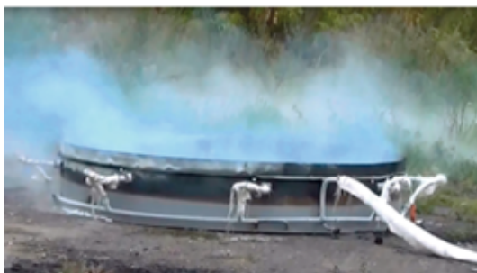
Рис. 2. Результат тушения дизельного топлива в макете резервуара РВС-5000, выполненного в масштабе 1 : 10
